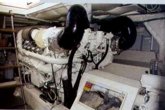
La sala macchine con i due Man V10 da 1100 cavalli common rail.
