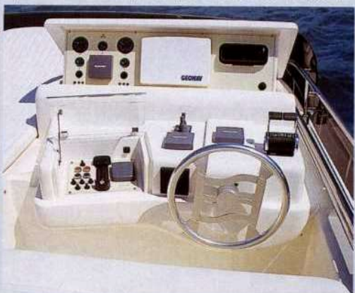
Sopra, il passavanti, sicuro e di buona larghezza. Sotto, la consolle del fly ha un pannello a scomparsa per la strumentazione.
